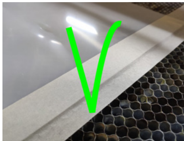
ATENCIÓN: corregir el problema usando cinta adhesiva
